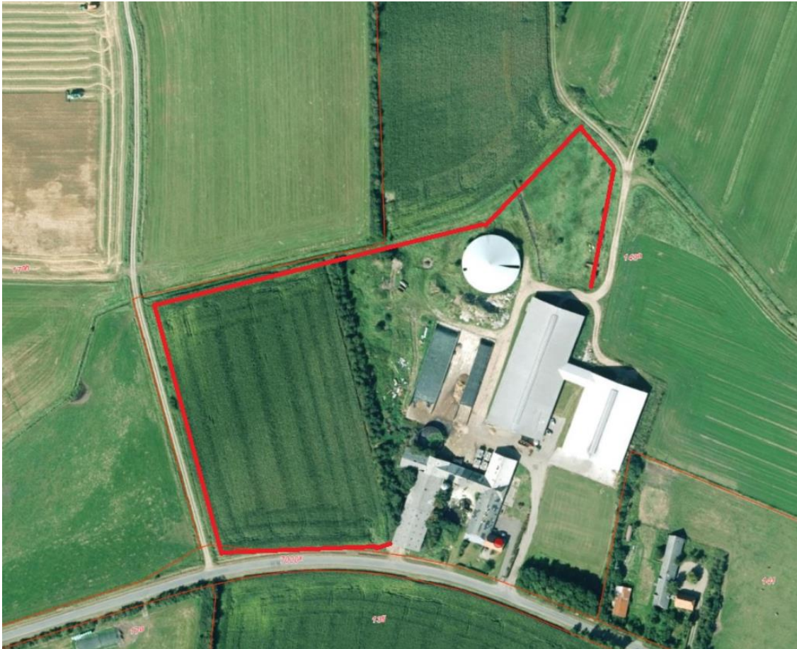
Kort 3: Skitse over placering af jordvold med henblik på at forhindre udslip af gylle til vandløb.
